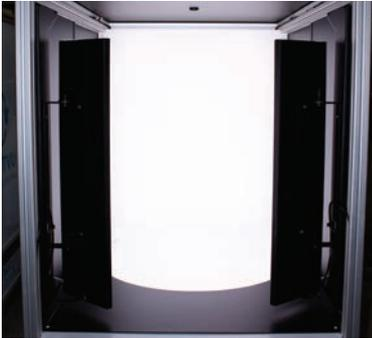
Ultra flache LED Paneele erweitern die Arbeitsfläche. Extrem Lange und verstellbare LED Paneele ermöglichen so attraktive & längliche Reflexe an Flaschen.
